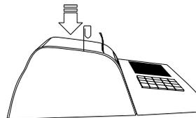
Porre il filo metallico in verticale e inserirlo per circa 4 centimetri, sino al raggiungimento della leva di apertura. Premere a fondo per qualche millimetro sino all'apertura dello sportello del vano carta.
